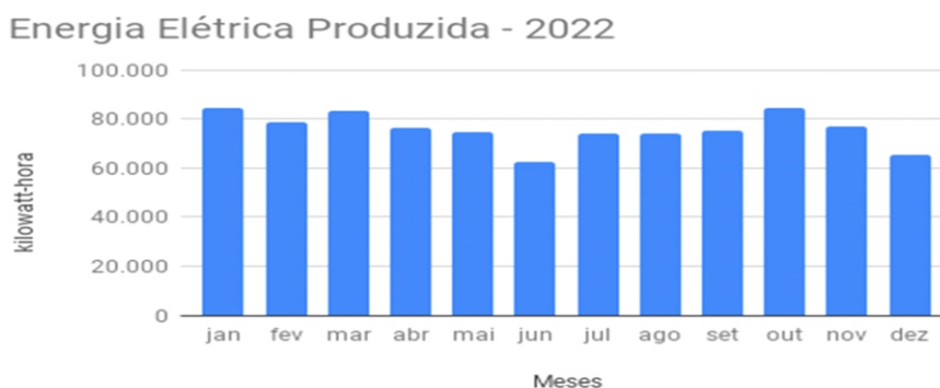
Figura 46 – Geração de Energia Fotovoltaica Mensal Total - IFSULDEMINAS 2022
