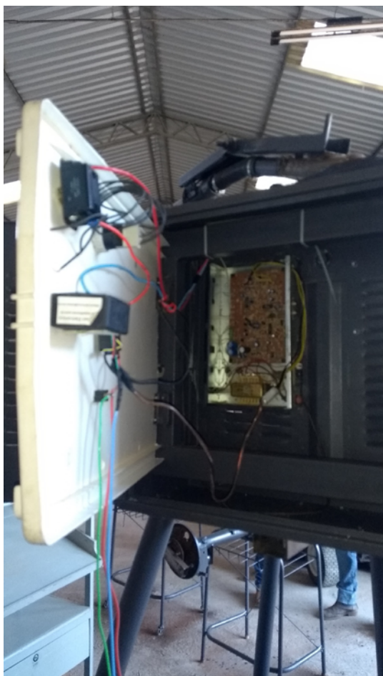
Figura 02: Montagem da parte eletroeletrônica do painel de controle do pivô feita em grande parte com equipamentos eletrônicos sucateados.
