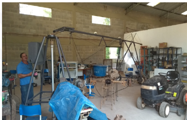
Figura 3: Montagem preliminar do pivô em laboratório.
